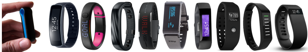
Abbildung 4.2. Der Fitbit Ultra (ganz links im Bild) ist ein sogenannter Aktivitäts-Tracker. Er rekonstruiert alltägliche Aktivitäten wie Gehen, Schlaf und Essen als Kennzahlen und berechnet daraus einen activity score. Der Sensor wird hierzu Tag und Nacht am Körper getragen und tauscht seine Daten mit einer zugehörigen Website aus. Vergleichbare Aktivitäts-Tracker sind von zahlreichen anderen Herstellern verfügbar, die mitunter auch als »multifunktionelle« Uhr am Handgelenk getragen werden (eine Auswahl ist im Bild zu sehen; von links: Samsung Gear Fit, Nike FuelBand, Jaw UP3, Polar Loop, Withings Pulse, Microsoft Band, Runtastic Orbit, Striiv Band und Fitbit Charge HR). Bildquelle Fitbit Ultra: eigene Fotografie, Bildquellen andere Tracker: Website des jeweiligen Herstellers.
